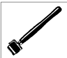
Валик Применение: для прикатки периферийных накладок и сварки пластмассовых полотнищ.
